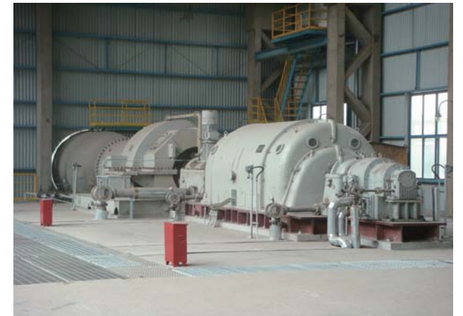
首钢迁钢 4000m 3 高炉余压发电 TRT 装置 Shougang Qiangang 4000m 3 BF TRT system
