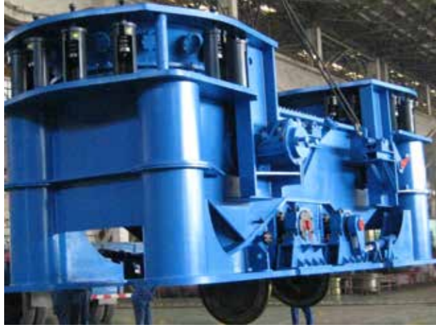
京唐5500 m 3 高炉无料钟炉顶部件在车间制作
