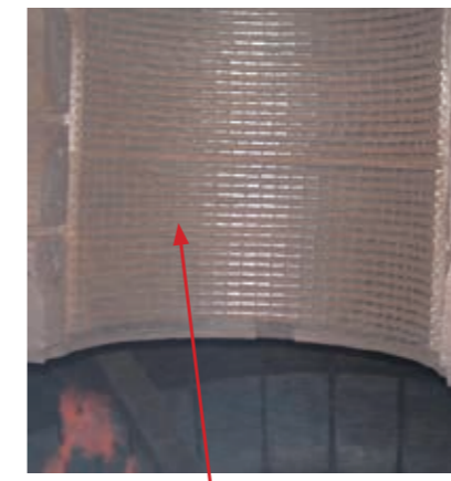
布料溜槽抗冲击耐高温弧面衬板
