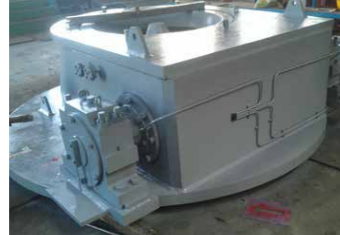
炉顶设备部件车间内制作完成
