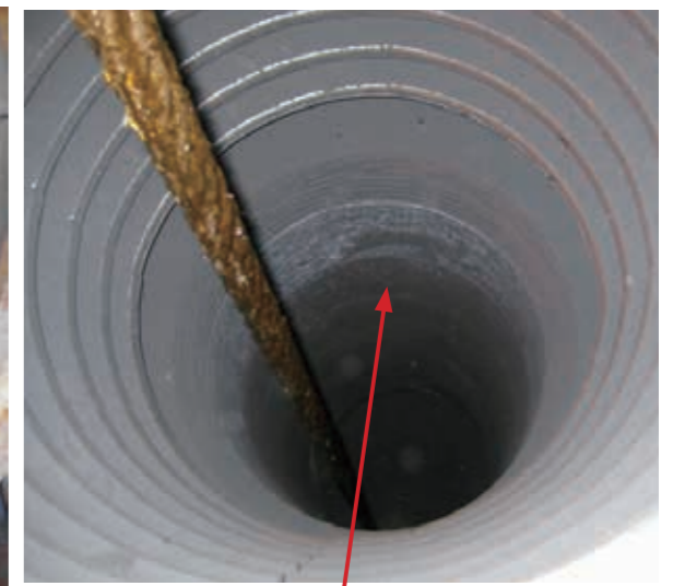
中心喉管抗冲击耐高温环状衬板
