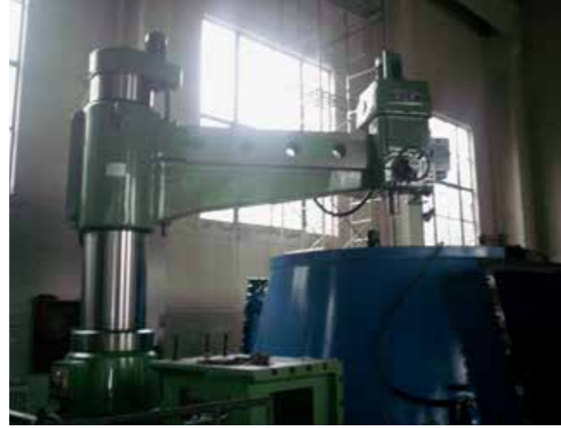
京唐5500 m 3 高炉无料钟炉顶部件在车间制作
