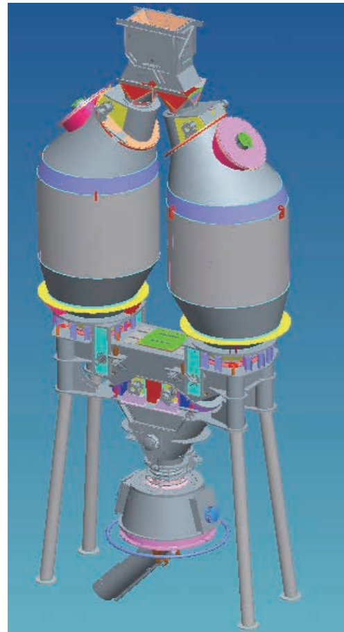
SGB型并罐无料钟炉顶三维模型
