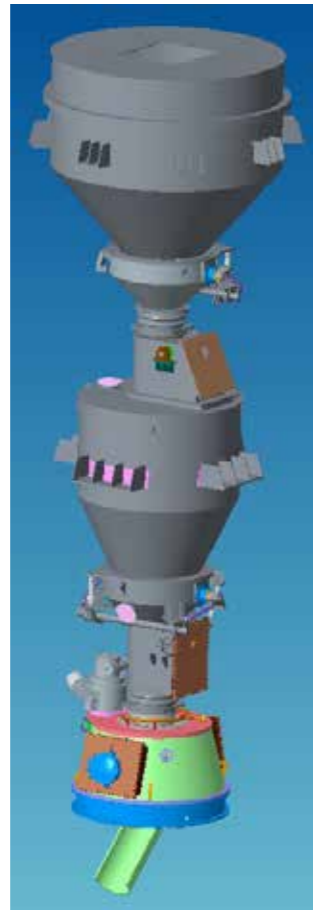
SGC型串罐无料钟炉顶三维模型
