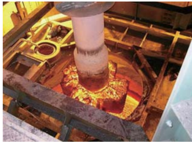
铁水 KR 脱硫 Hot metal KR desulphurization
