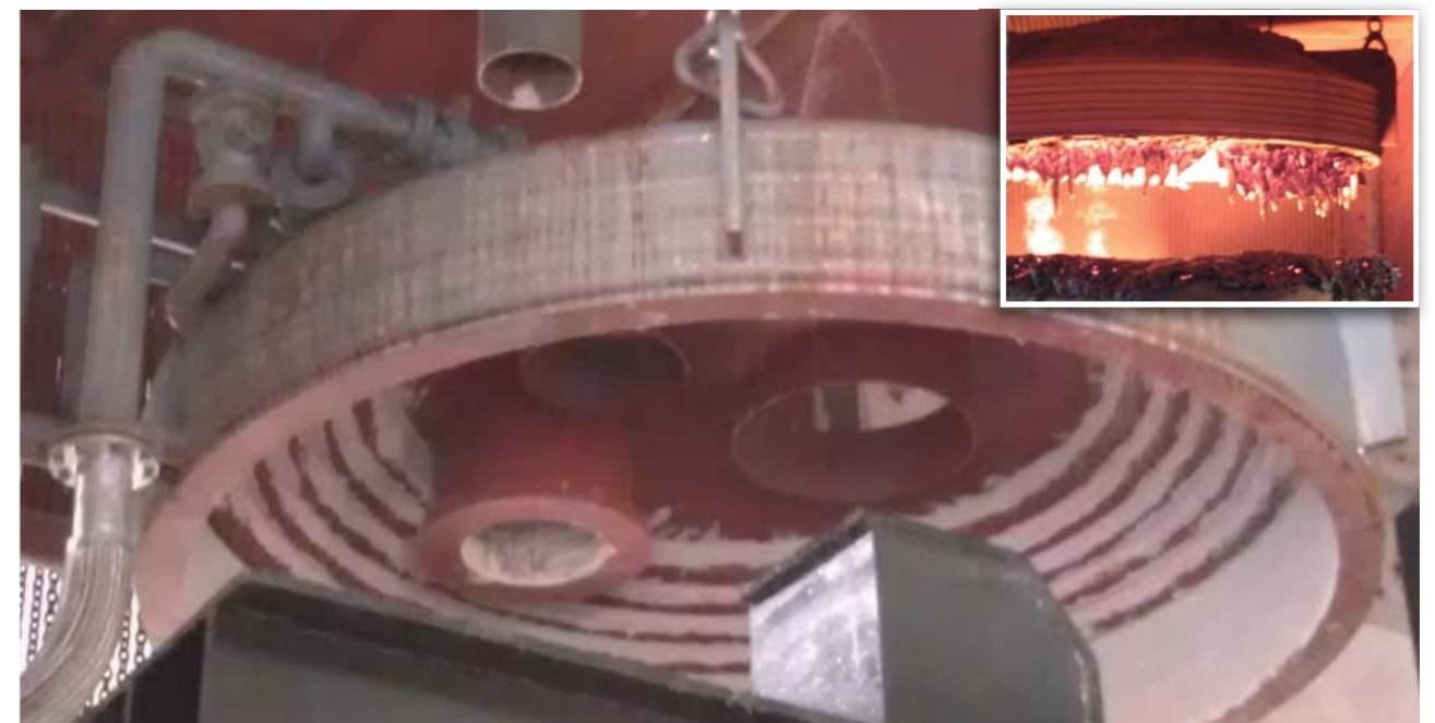
使用中的水冷防溅罩 Water cooling splash shield in use
